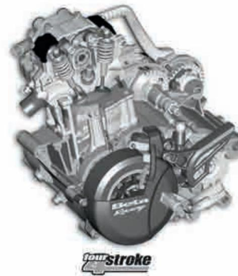
Das wassergekühlte 297cc-ohc-Kraftpaket wiegt nur 23 kg, atmet durch vier Titanventile und verdichtet 11,5:1 (Bildquelle: www.betamotor.com).
