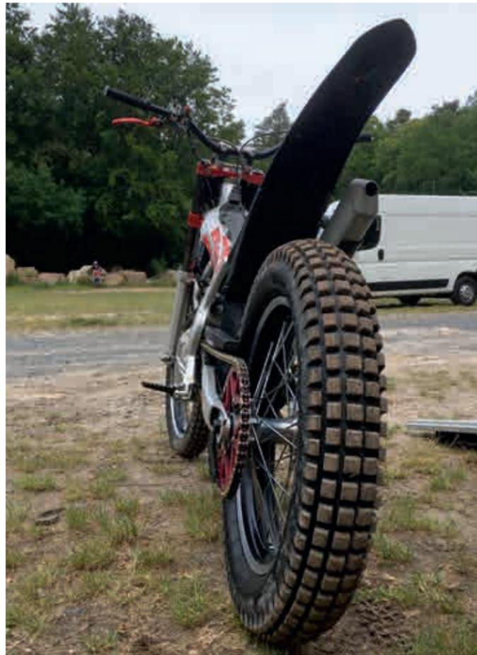
Der vordere 21 Zoll- und der hintere 18 Zoll-Reifen mit dem typischen Zuckerwürfelblockprofil bauen heftigen Grip auf. Auch, weil der Luftdruck im Fahrbetrieb nur unglaubliche 0,3 bis 0,4 bar beträgt. Haben die Felgen im Bereich der Nippel keine spezielle Abdichtung zur schlauchlosen Verwendung, dann müssen zusätzliche Reifenhalter in den Rädern verbaut werden, sonst können sich die Reifen auf den Felgen drehen und dabei die Schlauchventile abreißen.
